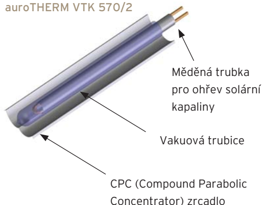
Detail trubice vakuového solárního panelu auroTHERM VTK 570/2
